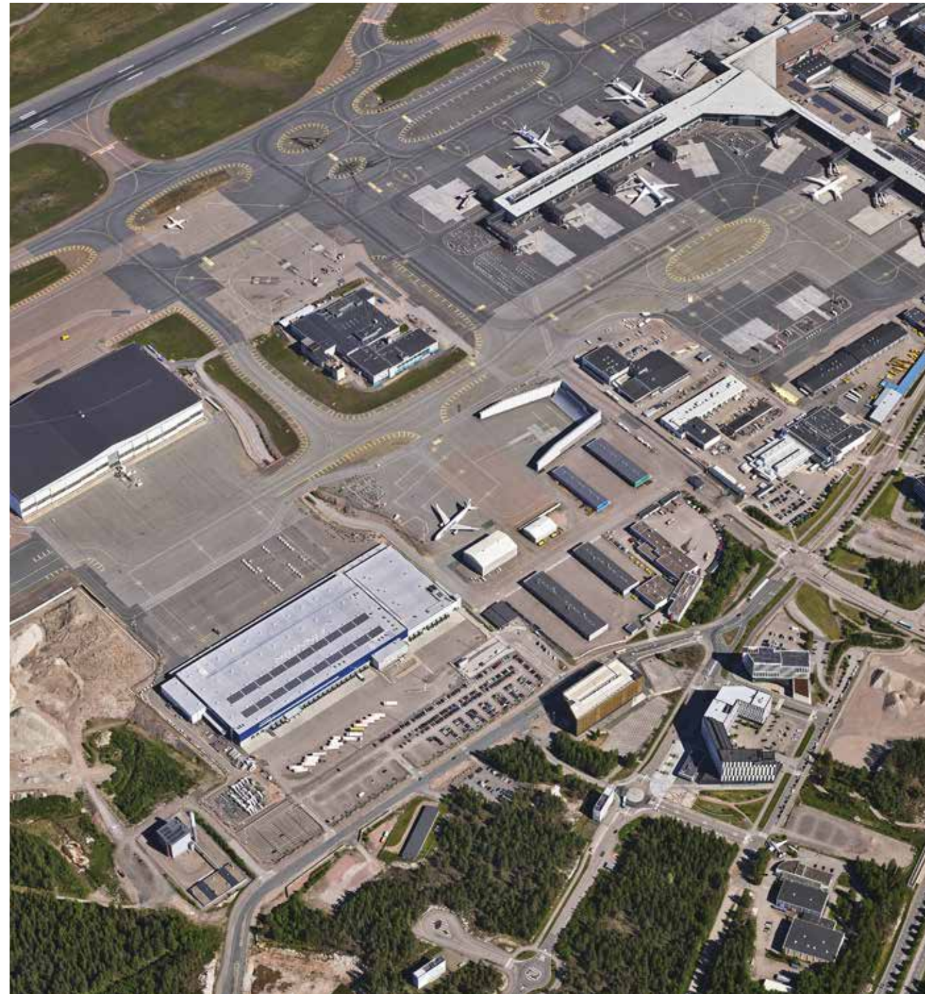
Kuva 25. Lentokoneiden huoltojen yhteydessä tehtävät koekäytöt suoritetaan korkeilla meluseinäkeillä varustetulla koekäyttöpaikalla. Koekäyttöpaikka on kolmisenäköinen rakenne kuvan keskiosassa. © Vantaan kaupungin karttapalvelu
